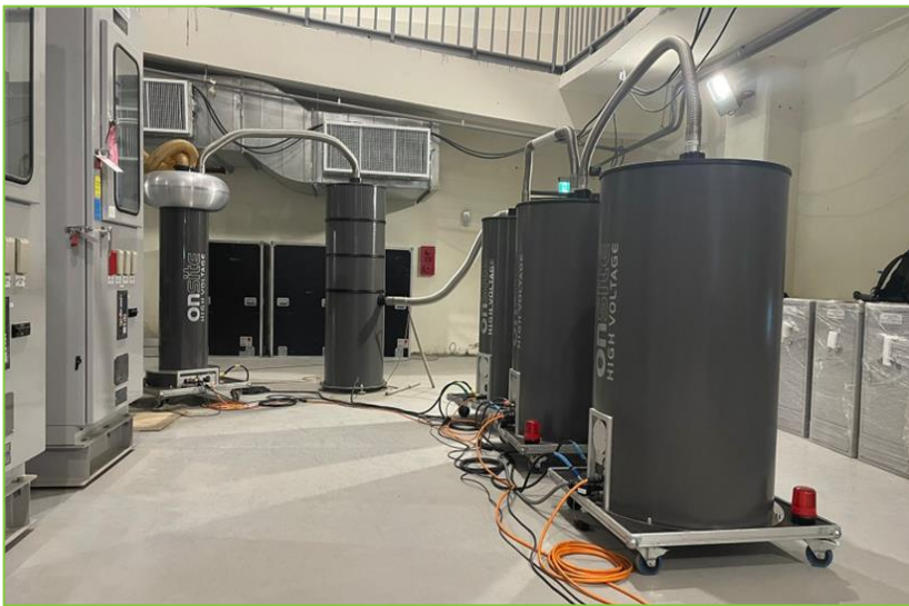
使用 300 kV 阻尼交流 (DAC) 系统进行出口电缆测试：主单元（带高功率）安装在陆上变电站（左侧），从单元（带双侧）安装在海上变电站（右侧）。
