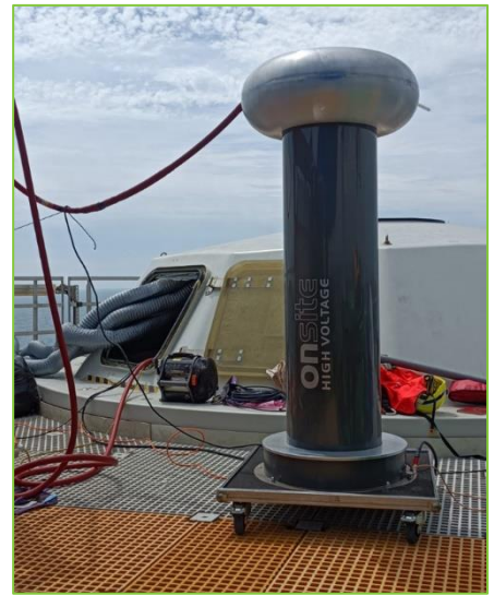
使用 300 kV 阻尼交流 (DAC) 系统进行出口电缆测试：主单元（带高功率）安装在陆上变电站（左侧），从单元（带双侧）安装在海上变电站（右侧）。
