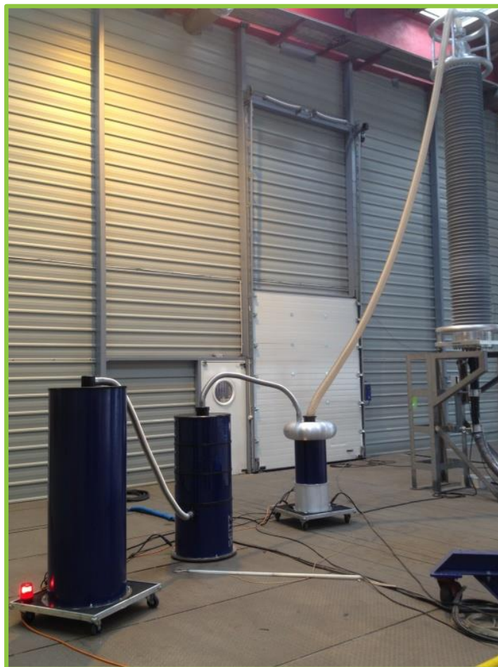
320 kV 高压直流电缆的阻尼交流测试与局部放电测量。
