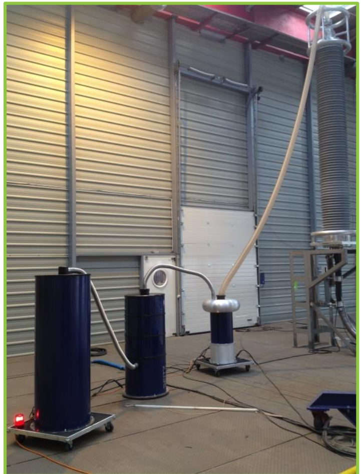
Test tłumionego prądu przemiennego z pomiarami wyładowań niezupełnych kabla HVDC 320 kV
