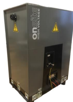
Tłumione napięcie przemiennego (DAC) 110 kV* wersja off-shore dla kabli do 66 kV
