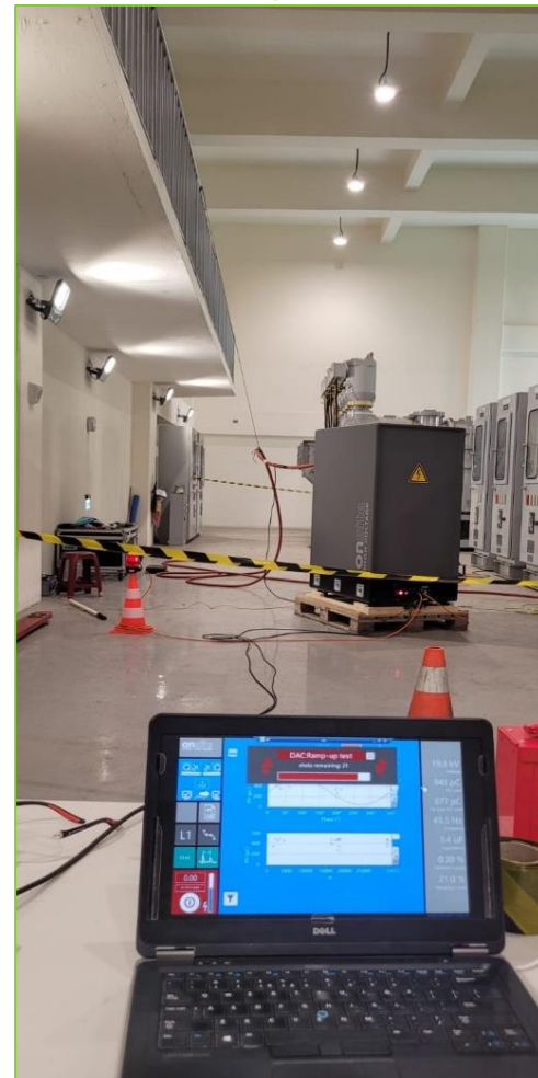
Testy kabli eksportowych przy użyciu systemu DAC HV110: Jednostka główna z Dual-Power zainstalowana na podstacji lądowej (na dole). Jednostka końcowa z Dual-Side zainstalowana na podstacji morskiej (na górze)
