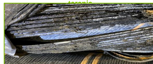
Przykłady uszkodzeń mechanicznych pancerza kabla między-turbinowego w terenie
