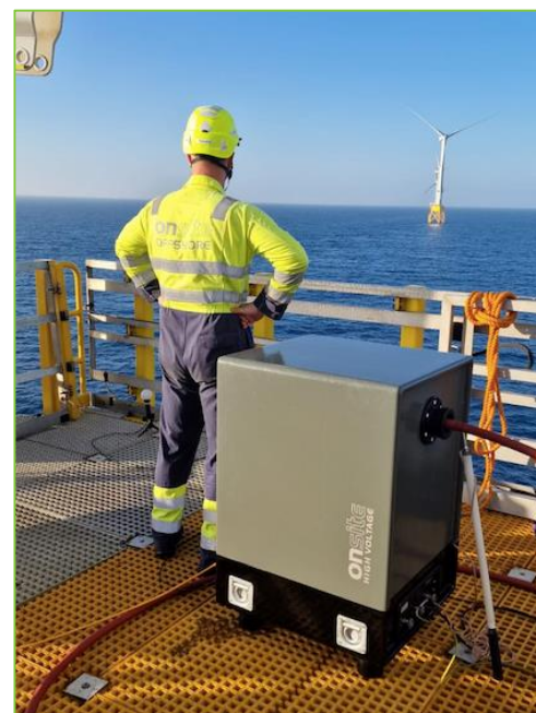
Testy kabli eksportowych przy użyciu systemu DAC HV110: Jednostka główna z Dual-Power zainstalowana na podstacji lądowej (na dole). Jednostka końcowa z Dual-Side zainstalowana na podstacji morskiej (na górze)
