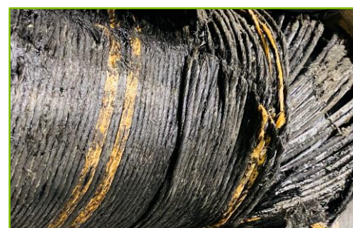
Przykłady uszkodzeń mechanicznych pancerza kabla między-turbinowego w terenie
