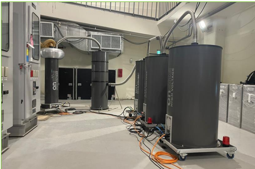
Testy kabli eksportowych przy użyciu systemu DAC 400 kV: Jednostka nadrzędna z High-Power zainstalowana na podstacji lądowej (po lewej) Jednostka przeciwnie z Dual-Side zainstalowana na podstacji morskiej (po prawej)
