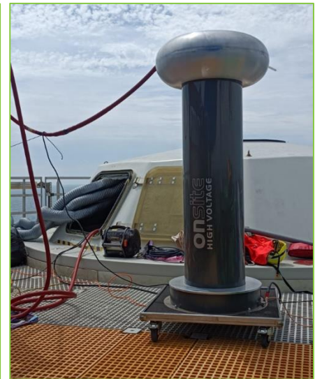
Testy kabli eksportowych przy użyciu systemu DAC 400 kV: Jednostka nadrzędna z High-Power zainstalowana na podstacji lądowej (po lewej) Jednostka przeciwnie z Dual-Side zainstalowana na podstacji morskiej (po prawej)
